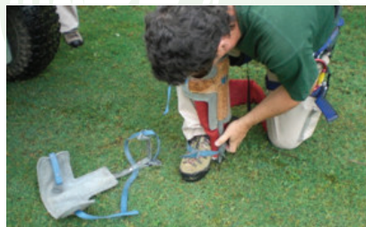
Figura 152 y 153. A la izqda., modelo de espuela; A la derecha, su colocación
